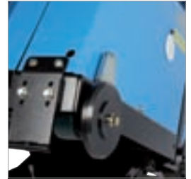
Einfacher und schneller Wechsel zwischen Links- bzw. Rechtsanbau des Sägeblatts
