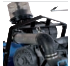
Ausbalancierter Transporthaken ermöglicht mühelosen Transport mittels Kran
