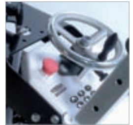
Anwenderfreundliche Schnitttiefeinstellung und komfortable Drehzahlregelung
