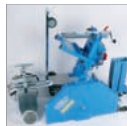
Einfachste Verladung und Beförderung der Maschine durch Zerlegbarkeit in Einzelteile
