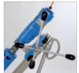
Universeller Einsatzbereich dank Schrägverstellbarkeit 90°-45°
