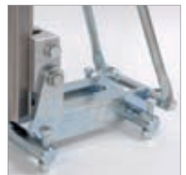
Bohren auf engstem Raum mit Stahl-Dübelbuss
