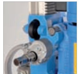
Ermüdungsfreies, ergonomisches Arbeiten dank Vorschub-Feingetriebe ( i=1:3,5 )
