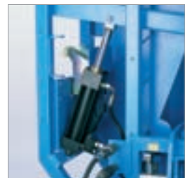
Ruhiger Lauf durch hydraulischen Seilspanner
