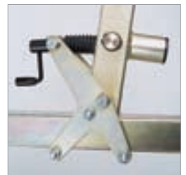
Seil lässt sich einfach einlegen und spannen
