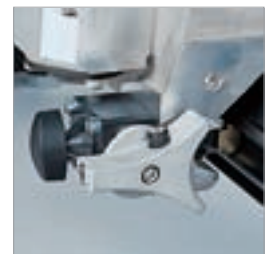
Einfache Sägekopfmontage dank Y-Schlittenführung mit Feineinstellung
