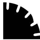
C1S weite Teilung, breite Schlitz Zusätzlich schräge Schutzsegmente gegen "undercutting"
